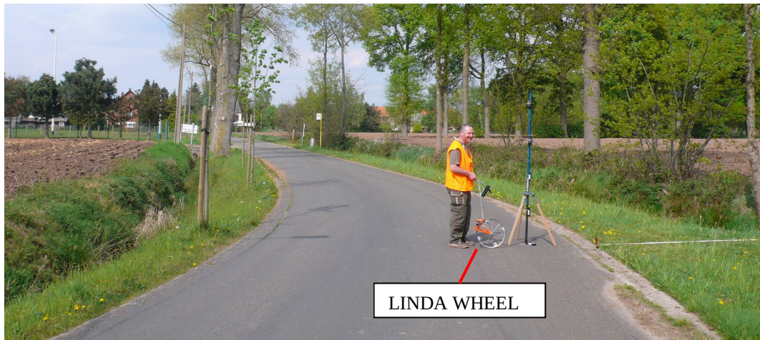
Figuur 4: Bepaling van ondergrondse kabellocatie
